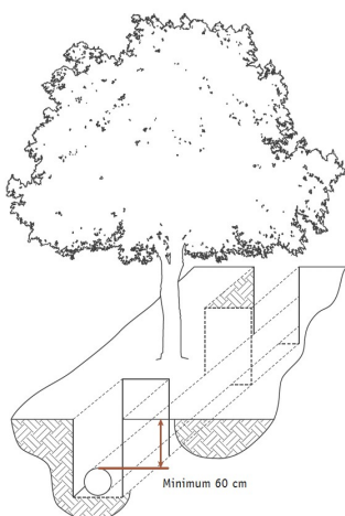
Schemat tunelowania na podstawie "Zabezpieczenie drzew na czas budowy", Marzena Suchocka i Monika Ziemiańska, 2013
